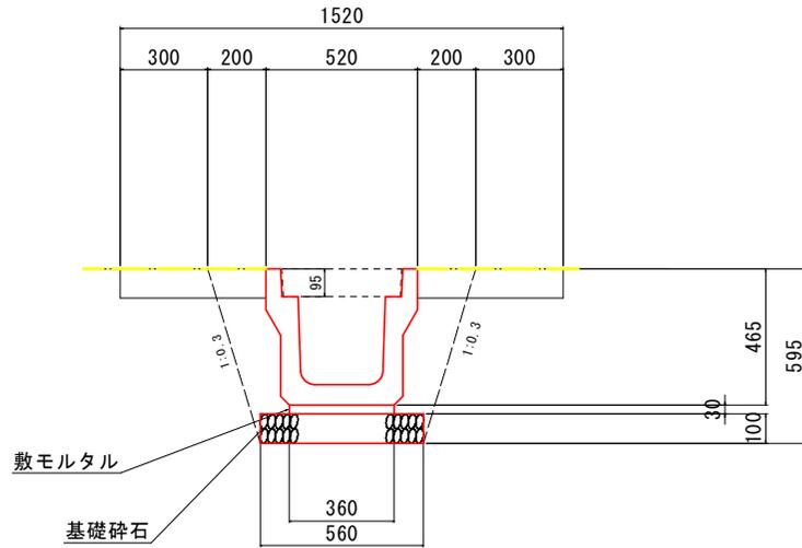
スチール製グレーチング かさあげ型 プレーンタイプ J I S型側溝用
